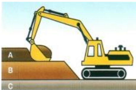
Abbildung 6: Vorgeschriebene Arbeitsweise für die Bodenabtragsarbeiten.
